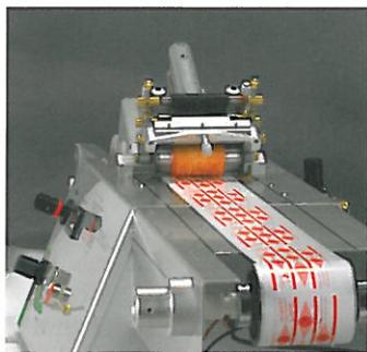
techniker unter realen Druckbedingungen Farbformulierungen erproben, ohne hierfür ein »Fingerprinting« an der tatsächlichen Produktionsmaschine vornehmen zu müssen. Hierfür ist das System mit einem Miniatur-Druckkopf, einer Raster- sowie einer Andruckwalze ausgestattet und kann Papiere und
